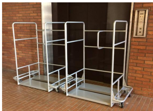
■ バックヤード移動の際、天井配管や梁が干渉するため、 テーブル積載時にH1680以下になるよう低床台車を製作しました。
